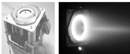
FIGURE 1 – Moteur plasmique en fonctionnement (droite)
