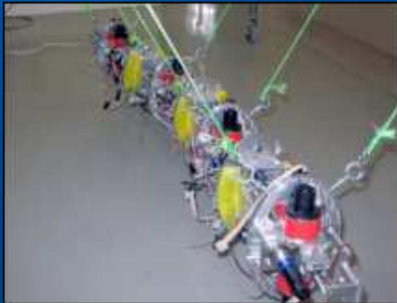
*5 vertèbres équipées de la peau pour les tests d'étanchéité et mouvements dans l'eau.*
