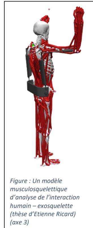
Figure : Un modèle musculosquelettique d'analyse de l'interaction humain – exosquelette (thèse d'Etienne Ricard) (axe 3)
