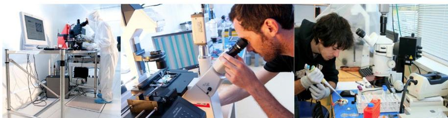
Plateforme de micro-technologie : Surface : 80 m<sup>2</sup>, Classe 10000, Concentration particulière maîtrisée, Régulation de température et d'humidité, Lumière inactinique.
